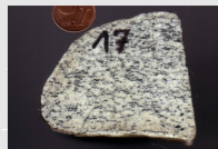
Anschnitt eines Quarz-Feldspat-Gerölls, das außen mit einer dünnen Glashaut überzogen ist. Während die hellen Quarze überlebt haben, sind die Feldspäte weitgehend zu einem Glas umgewandelt, das partiellweise dunkel gefärbt ist und das faserige Gefüge erzeugt.
