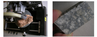
Aus dem Gestein wird ein Riegel heraus gesägt, der auf einem Glasträger so dünn geschliffen wird, dass er durchsichtig wird.
