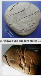
Spallationsrisse in einem natürlich geschockten Quarzit-Geröll, Rubielos de la Cérda-Impaktstruktur.
