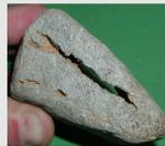
Spallationsrisse, Gerölle vom Tüttensee-Ringwall und aus dem Krater D16
