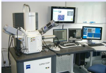
Feldemissions-Rasterelektronenmikroskop (FE-REM) SUPRA 55VP (Carl Zeiss NTS GmbH) mit Adaption der energie- und wellenlängendispersiven Analytik (INCA X-Max80 und INCA Wave) sowie das EBSD-System HKL Channel5 (OXFORD Instruments) ...
